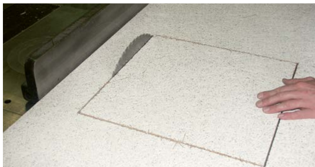
Couper l'ouverture/la plaque de couverture par le dos du panneau.
